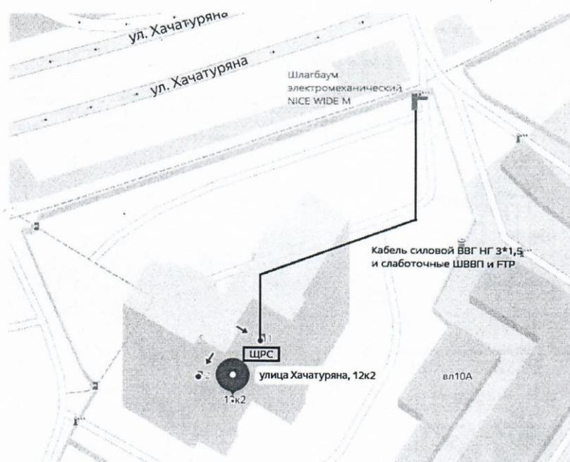
Рис. 1 Схема размещения шлагбаумов
